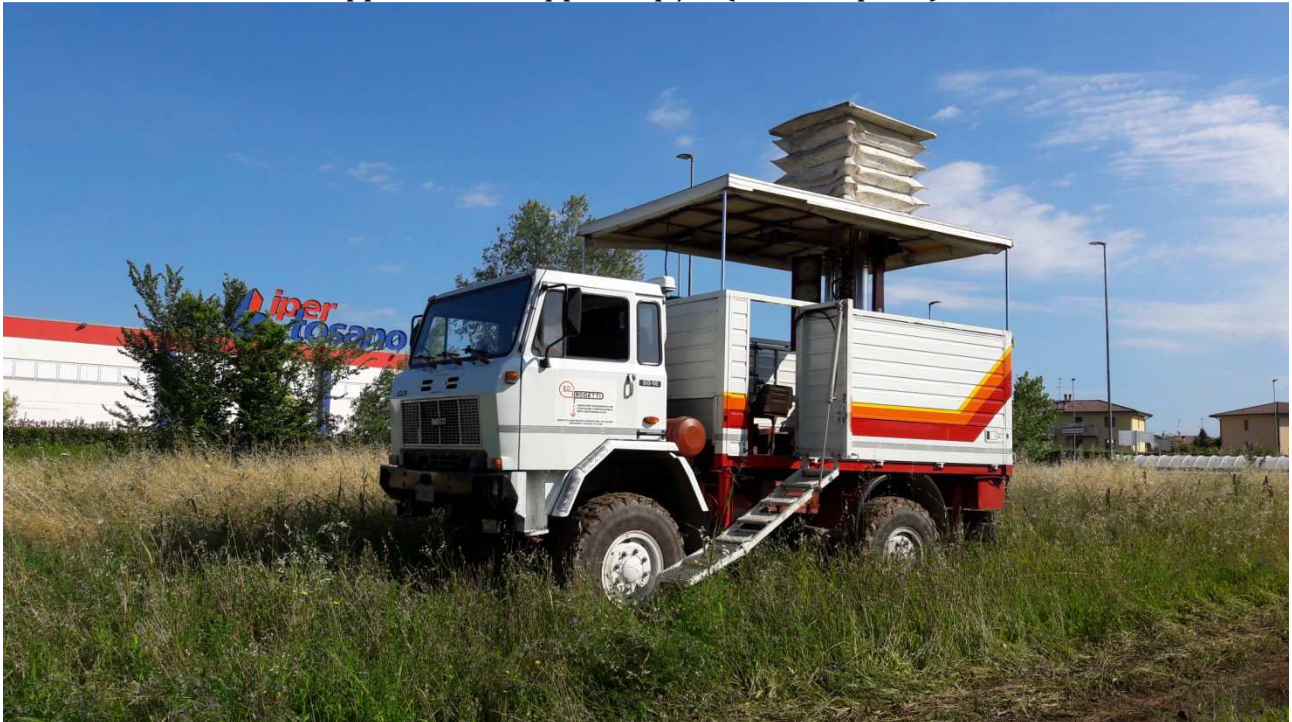
Fig.8. Penetrometro statico da 300 KN, montato su camion IVECO, utilizzato in sito.
