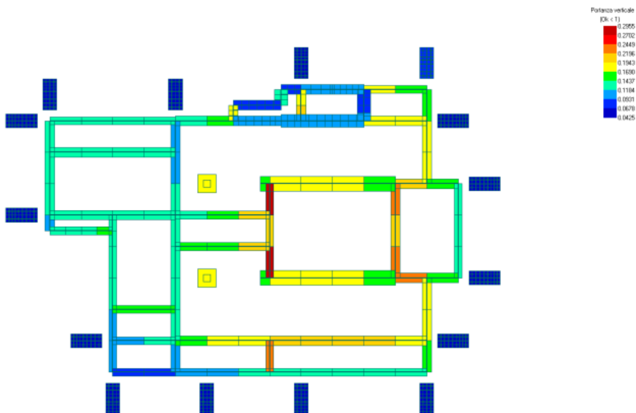
Figura 21: verifiche portanza verticale travi di fondazione esistenti
