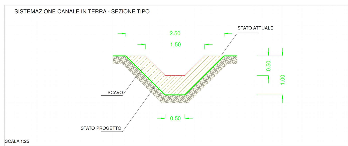
Figura 10 Sezione Tipo Intervento sistemazione canale in terra
