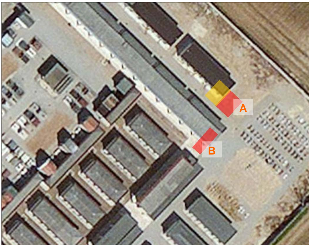
Foto 3a. Estratto ortofotopiano con individuazione delle aree di intervento: con campitura gialla il nuovo deposito attrezzature; con campitura rossa e lettere A e B le nuove batterie di nicchie per urne cinerarie.
